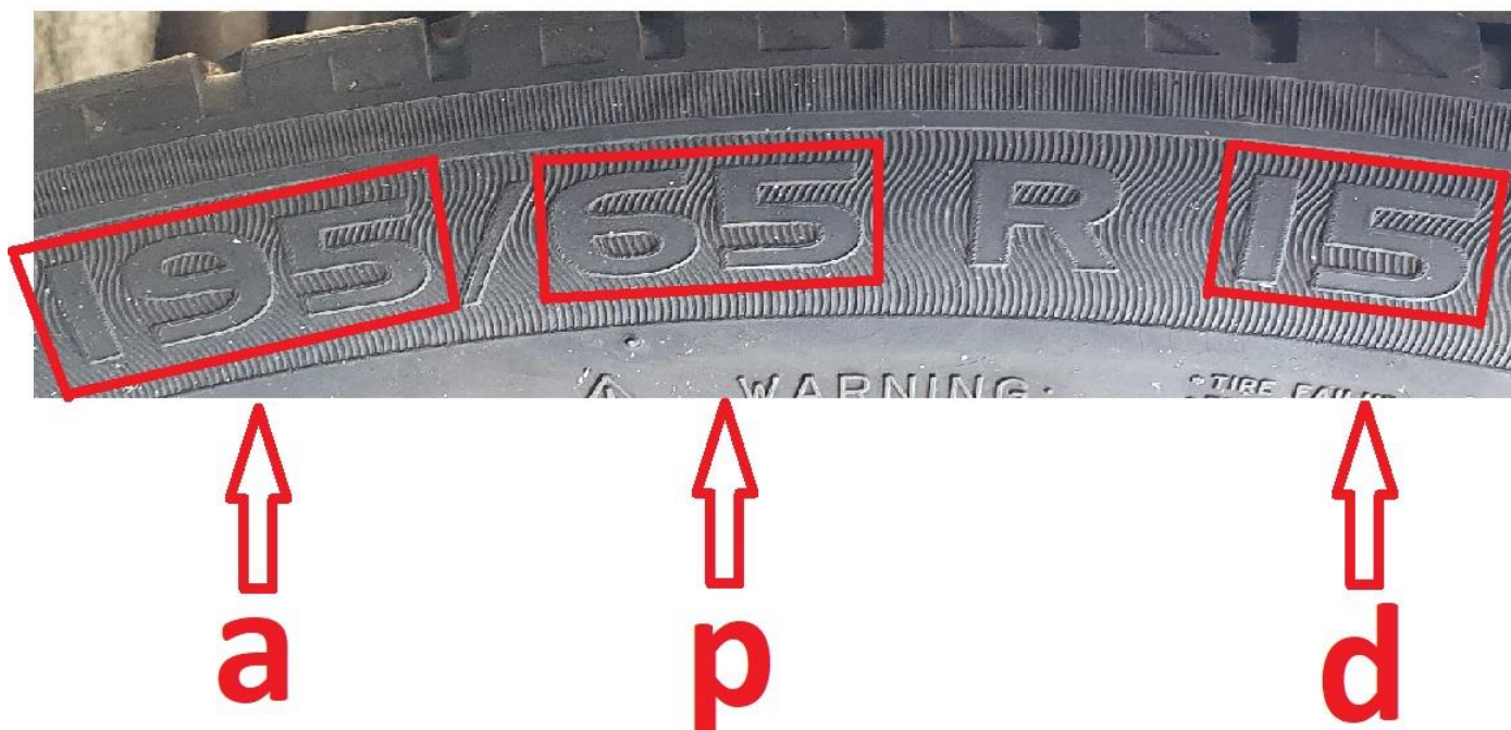
Rysunek 4. Rozmiar opony zamontowanej na feldze stalowej w pojeździe klienta
