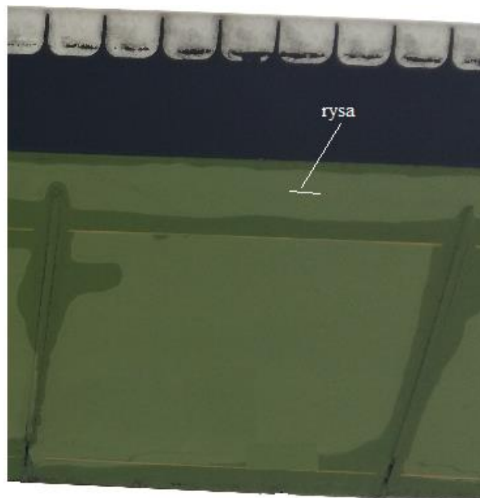
Rys.2 Uszkodzenie dźwigara (rysa) łopaty nr WK 5084952
