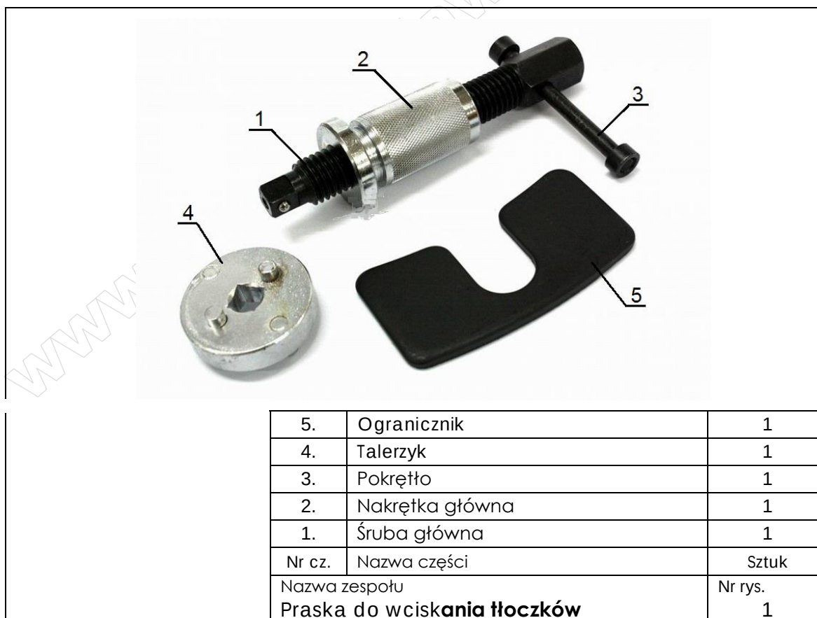
Rysunek 1. Praska do wciskania tłoczków
